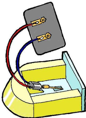
7 Effectue les soudures qui permettent de raccorder la cellule solaire au moteur, puis assemble le moteur et l'arbre moteur.
